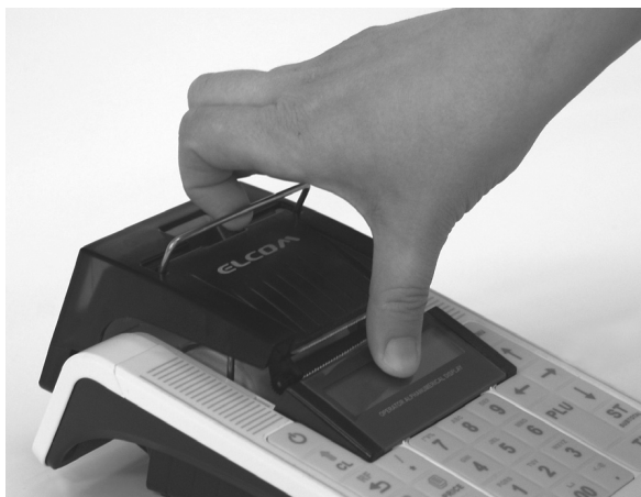
Obrázek 2.7 - Otevírání krytu pásky
